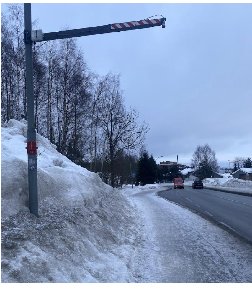
Figur 27 Snøsensor på Konnerud 2023-02-01 med brøytekant som siger inn i målefeltet (Foto: Applied Autonomy)
