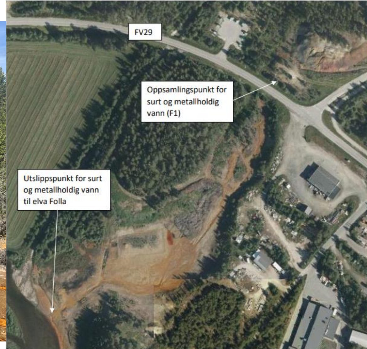
Figur 1 Oversikt over område nedenfor FV29 der surt og metallholdig vann samles opp og renner ut i elva Folla (foto: finn.no/kart)
