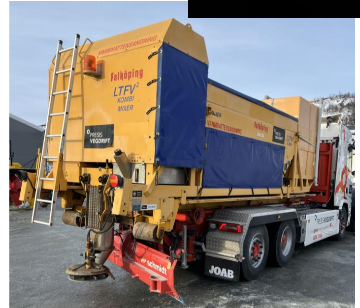
Fullutstyrt brøytebil med fastsandspreder og bakmontert høvelskjær
