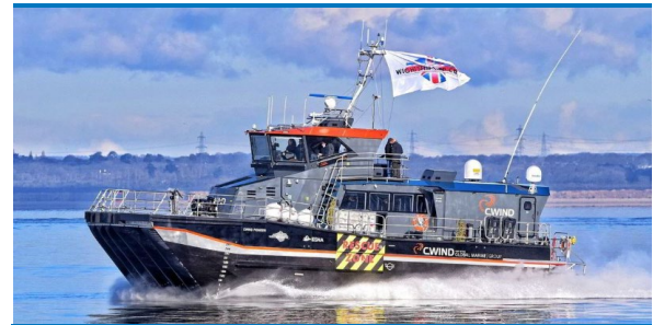
Figur 4-9: CWind Pioneer, SES-fartøy med hybridmotor
