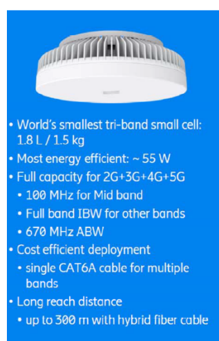
Figur 16: Spesifikasjon av typisk aksesspunkt for 5G mobilnett
