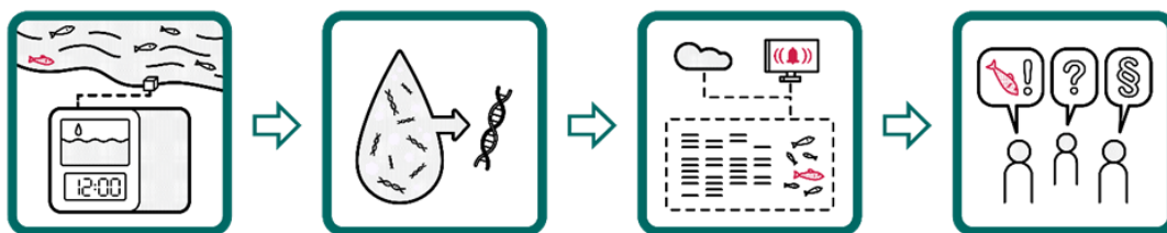
Figur 1. Illustrasjon av de ulike trinnene i automatisk miljøovervåking. Første bilde viser en kontinuerlig innsamling av prøver fra vann. Deretter bearbeides prøvene og DNA tas ut. Til slutt analyseres prøvene og varsel sendes om noe uønsket oppdages. En slik innretning vil gi mulighet for å sette inn tiltak tidlig for å begrense og hindre skade.
