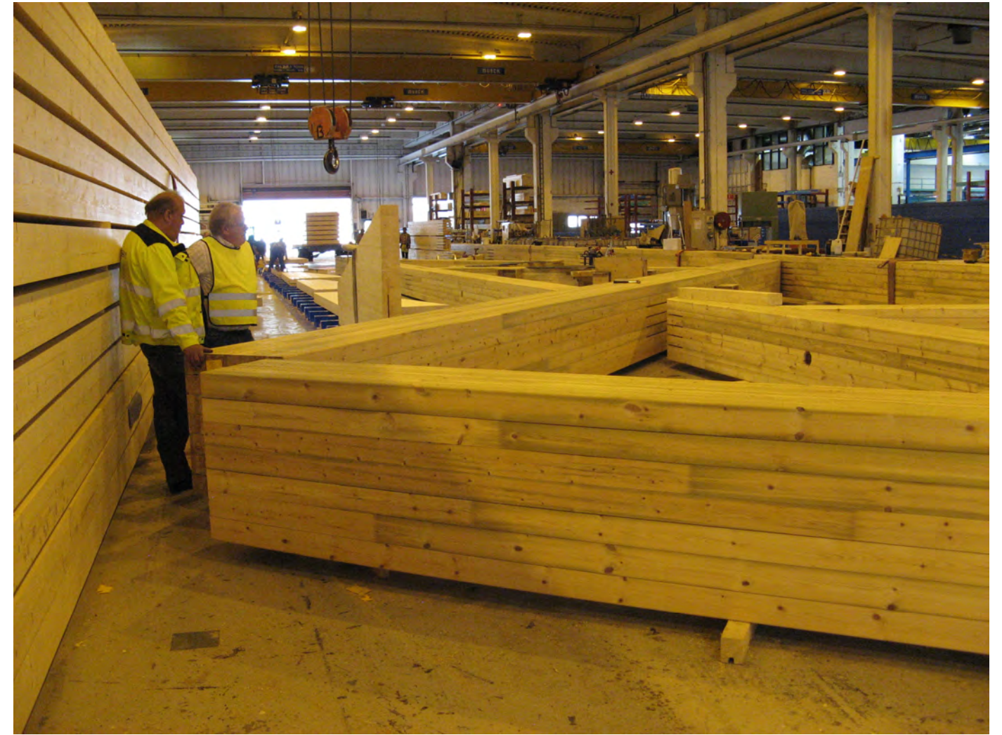
Figur 74 Store dimensjoner på limtrebjelkene
