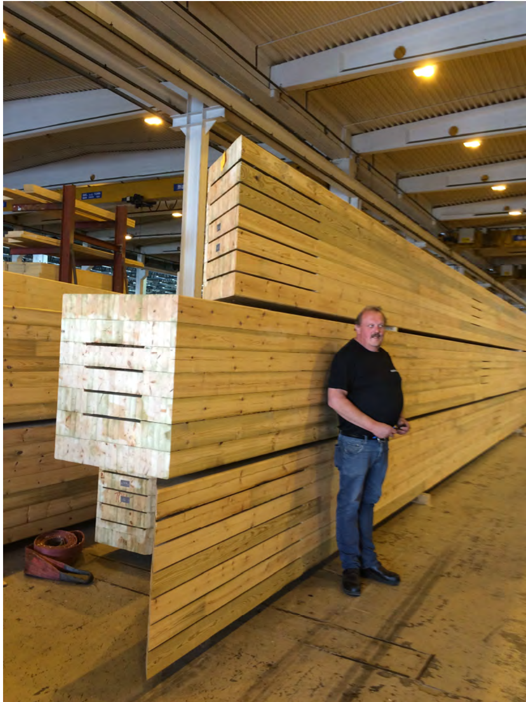
Figur 75 Store dimensjoner på limtrebjelkene
