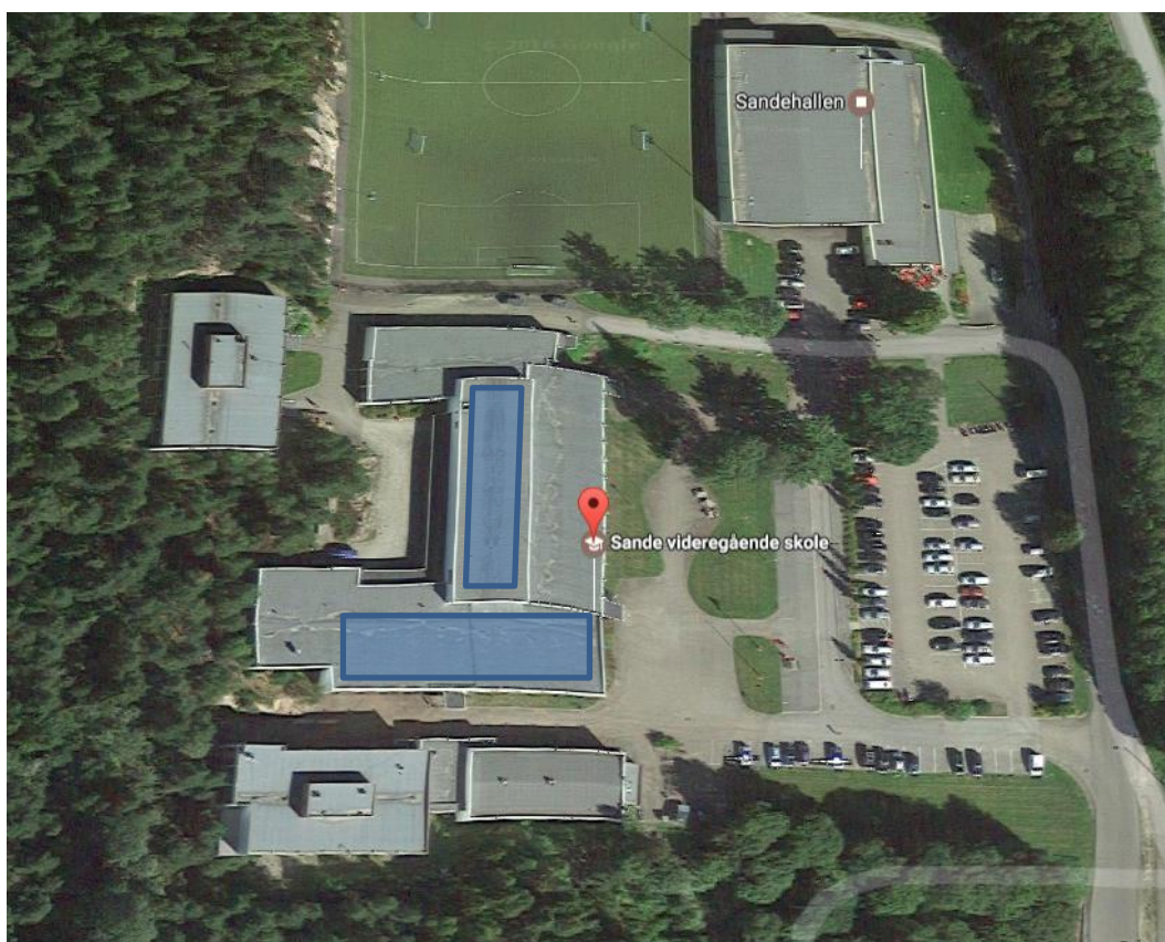
Figur 11 – Markering av de aktuelle takflater på Sande VGS for solcelleanlegg. Det er plass til ytterligere solceller distribuert på de ulike takflatene, men dette vil ytterligere øke andel eksportert strøm til nettet.
