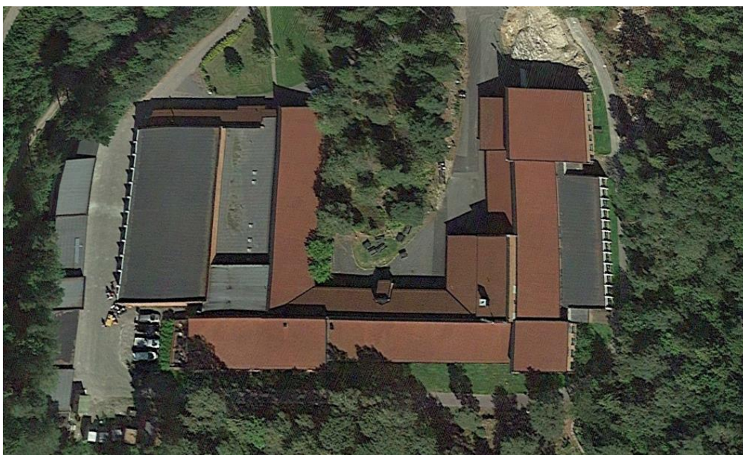
Figur 36 – Takflater på Re VGS. Skolen domineres av skråstilte takflater mot øst og vest, noe mot nord og mot sør på takflater nær skogen. Sørvendte takflater er delvis skjermet av trær.
