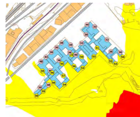
Støysonekart for havn iht T-1442/2016, med impulsstøykorreksjon. Gul sone viser nivåer over Lden 50 dB og rød sone verdier over Lden 60 dB.
